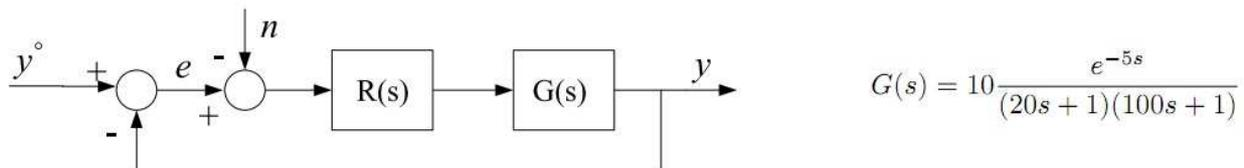
Si determini la funzione di trasferimento del regolatore  $R(s)$  in modo che:
