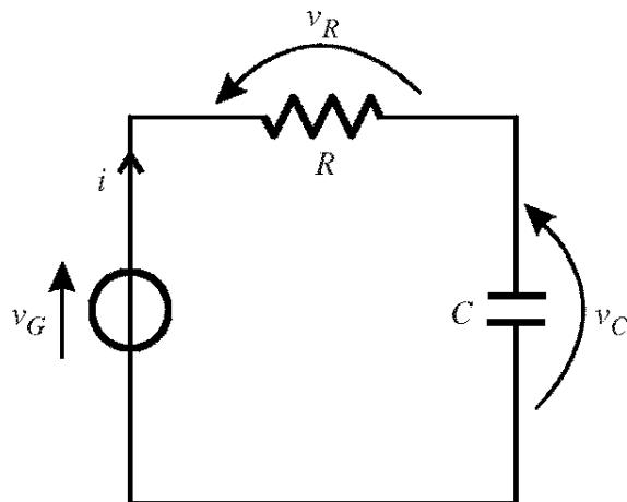
$$C\dot{v}_c = i \quad \text{Equazione del condensatore}$$
