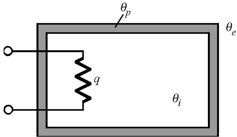
Capacità termica del forno  $C_f$
