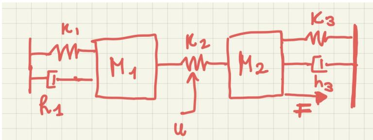
Il sistema è costituito da due masse collegate tramite molle e smorzatori. Gli ingressi del sistema sono la forza  $F$  e  $u$ . Quest'ultimo controlla il coefficiente elastico variabile della molla  $k_2$  secondo la seguente equazione
