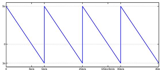
Figura 3: Andamento delle scorte nel modello di lotto economico con rottura dello stock. Si noti come la durata del ciclo sia sempre pari a  $Q/a$  anche se la giacenza ad inizio ciclo risulta minore.
